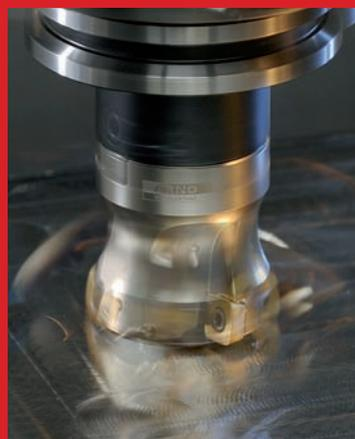
Инструмент и сменные пластины для фрезерной обработки и резбифрезерования
