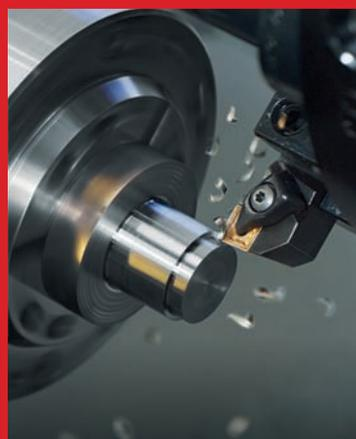
Инструмент и сменные пластины для токарной обработки и обработки резьбы
